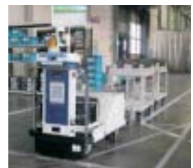
改善後：循環型搬送台車を導入し、人による積替え作業は廃止されました
