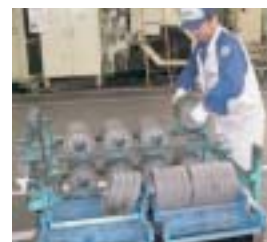
群馬製作所大泉工場での作業改善の例 改善前は、作業者が手で重量部品の積替えを行っていました
