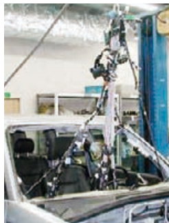
ワイヤリングハーネス類の解体性向上
