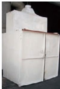
(株)イチタンのバリ落下音対策を施したバリ箱用防音室
