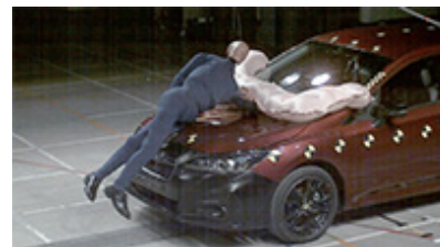
国産車初の歩行者保護エアバッグ搭載車両による衝突試験
