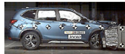
フォレスターのJNCAP※オフセット前突試験画像 提供：自動車事故対策機構
