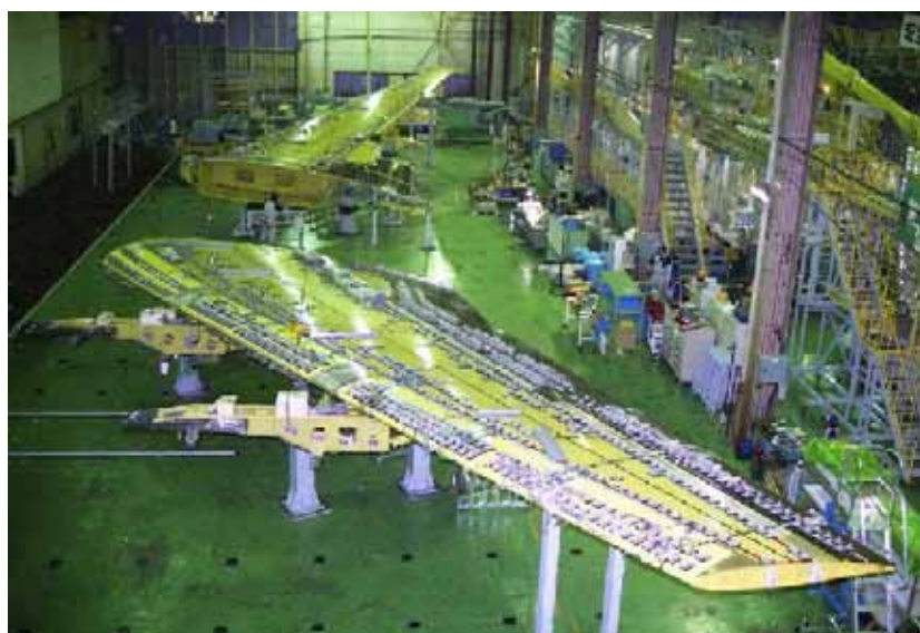
納入準備中の次期固定翼哨戒機静強度試験機用主翼
