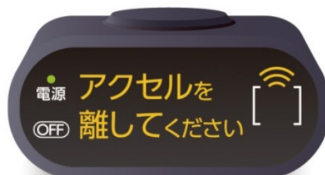
ペダル踏み間違い時加速抑制装置 車載インジケーター(作動時イメージ)
